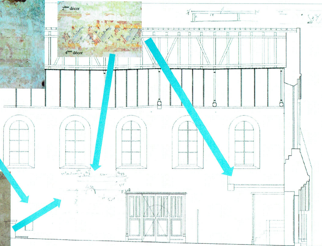
Nef – Mur Sud – Relevé et Situation des sondages sur Plan de A. de Saint-Jouan ACMH
